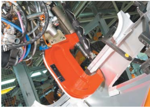
Vollstanznietprozess in der Produktion
