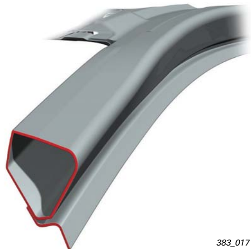
A-Säule Audi A8 Einkammer Strangpressprofil
