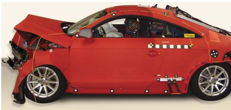
Euro NCAP Frontcrash (64km/h mit teilweiser Überdeckung)
