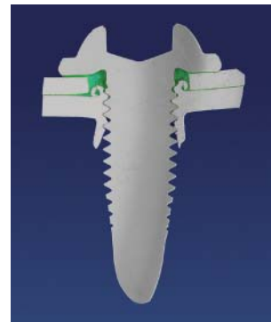
Schliffbild einer Flow Drill Verschraubung
