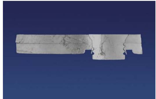
Schliffbild einer Vollstanzniet Verbindung
